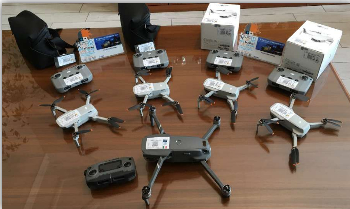
La flotta di APR disponibile presso l'ITIS Q. Sella di Biella: 4 DJI Mini2 per le attività di Educazione al volo, il Mavic 2 Pro per le applicazioni curricolari specifiche nel campo della rappresentazione grafica CAD 2 e 3D. L' ITIS Q. Sella è "operatore APR" della PA registrato nel rispetto delle normative vigenti.
